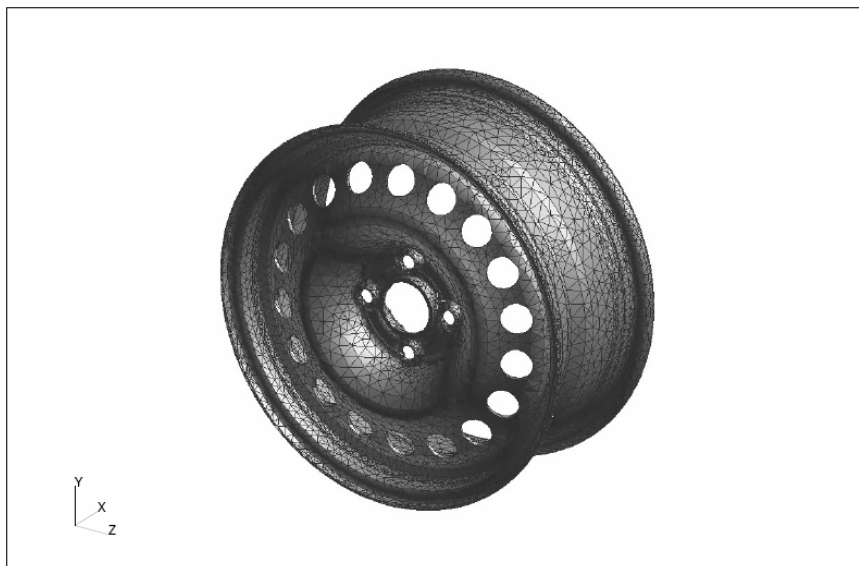
Figura 42: Modelo em elementos finitos da roda em estudo
