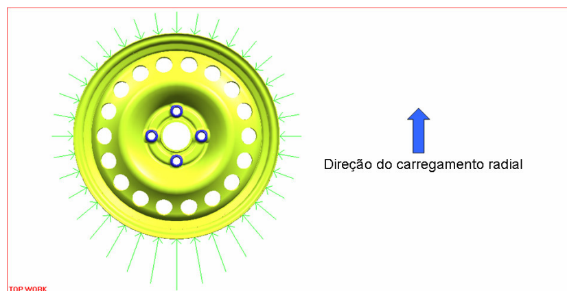
Figura 40: Distribuição da pressão de contato sobre o flange do aro
